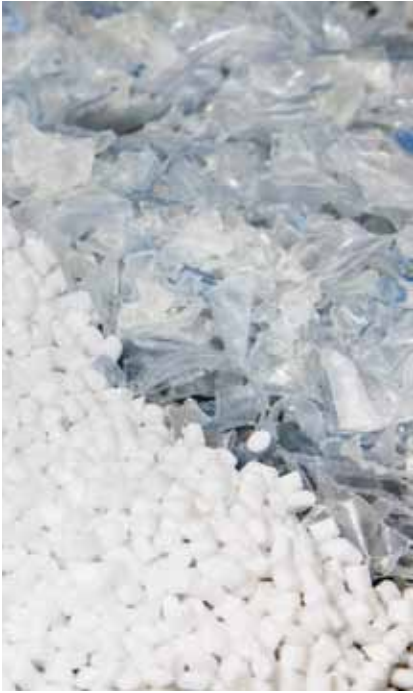
▲ แผ่นพลาสติกและเม็ดพลาสติก PET ที่ผลิตจากขวดพลาสติก PET รีไซเคิล
